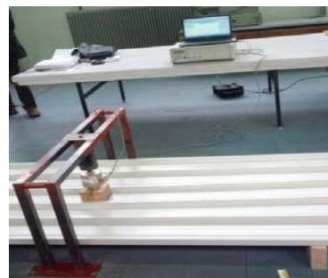
Slika 6. Ispitivanje lima-opterećenje silom i mjerjenje
