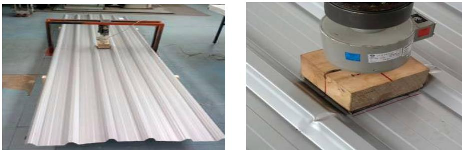
Slika 3. Položaj trapeznog lima debeljine 0,50 mm na osloncima pri rasponu od 1900 mm, izgled lima nakon pojave trajne deformacije
