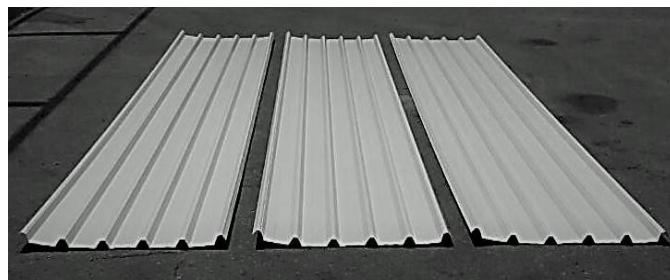
Slika 1. Uzorci trapeznog lima za predispitivanje
