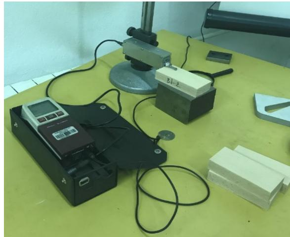
Slika 5: Mjerenje hrapavosti – elektrotehnički profilmeter
