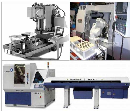
Slika 6. Sustavi za automatiziranu izmjenu obradaka
