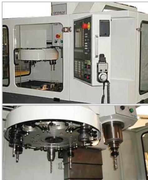
Slika 2. Automatizirani sustav izmjene alata sa magacincima za 10 alata [4]
