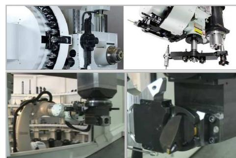
Slika 5. Izmjena alata primjenom poluge i robota
