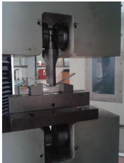
Slika 2.4. Oprema za ispitivanje mehaničkih karakteristika savijanjem
