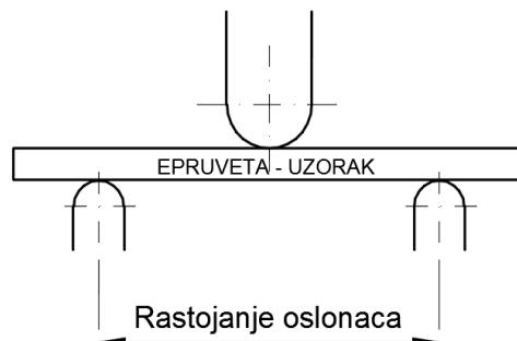
Slika 2.5. Šema postupka ispitivanja savijanjem
