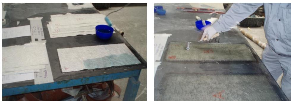
Slika 1.2. Ručni postupak izrade kompozita
